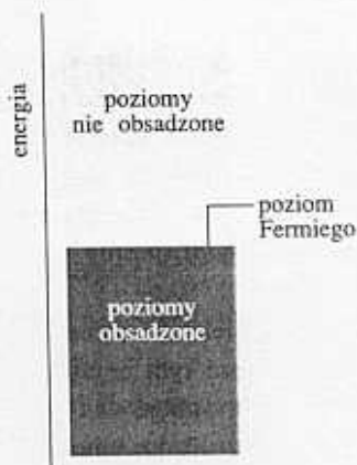
14.48 Gdy w paśmie utworzonym z N orbitali znajduje się N elektronów, pasmo to jest wypełnione tylko połowicznie i elektrony w pobliżu poziomu Fermiego (najwyższego zapelnionego poziomu) mają swobodę ruchu
