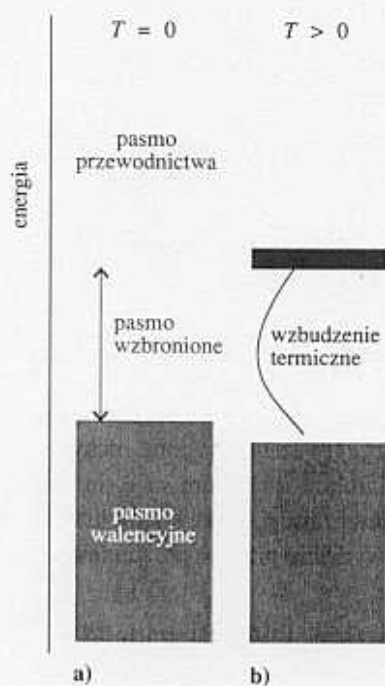
14.50 a) Gdy w paśmie obecnych jest 2N elektronów, pasmo to jest całkowicie wypełnione i w T = 0 materiał taki jest izolatorem. b) W temperaturze powyżej T = 0 elektrony obsadzają pasmo przewodnictwa kosztem wypełnionego pasma walencyjnego i materiał staje się półprzewodnikiem
