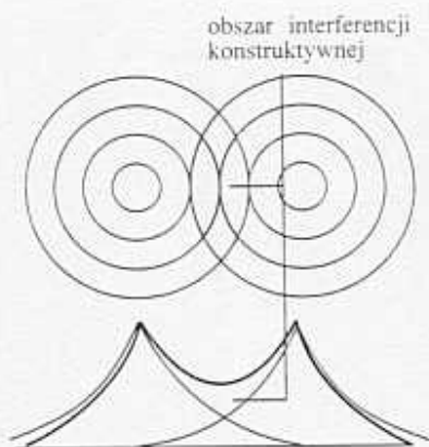
14.17 Schematyczna ilustracja interferencji konstruktywnej, występującej podczas nakładania się na siebie dwóch orbitali H_{1s} i utworzenia orbitalu wiążącego \sigma . Porównaj z rys. 14.14
