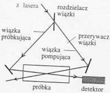
17.34 Schemat konfiguracji promieniowania laserowego stosowanej w spektroskopii nasyceniowej
